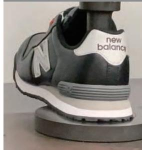
圧迫力を加える(10±3mm/minの速度)
